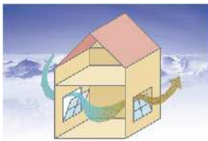
Επίπεδο σύστημα βασικού αερισμού με μηχανικό αερισμό
